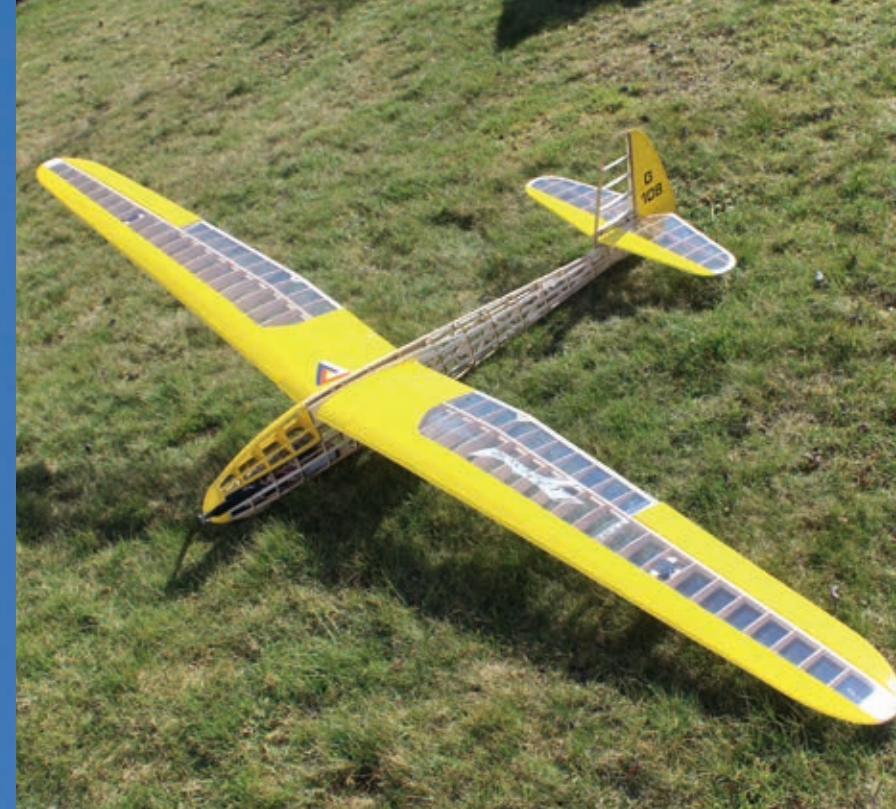
Der Lippisch G108 ist einem Freiflugmodell aus den 1930er-Jahren nachempfunden und mit 2.750 mm Spannweite kein kleiner Oldtimersegler
