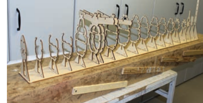
Alle Rumpfspanten sind mit Füßchen versehen, um diese auf die Helling zu stecken
