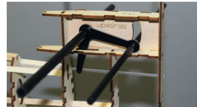
Sowohl beim Steuern als auch beim Einstellen der EWD bietet das Pendelhöhenruder Vorteile
