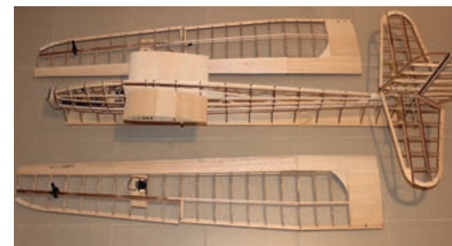
Rohbaufertig zum Bespannen mit der Folie FixIt!, die ebenfalls bei Pichler erhältlich ist
